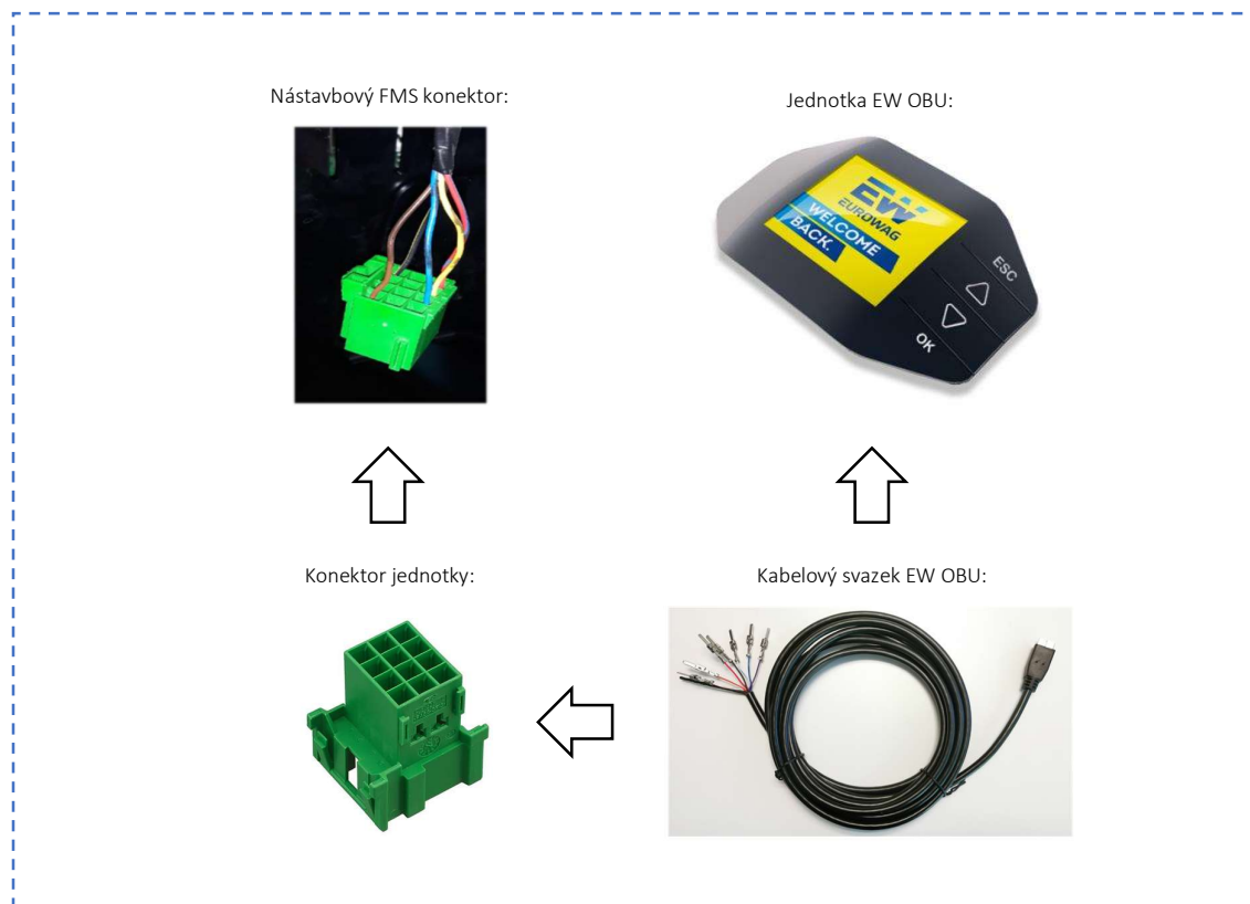
Základní schéma připojení k nastavbovému FMS konektoru bez připojení tachografu
